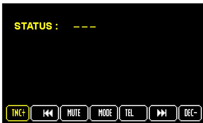
5. Нажмите и удерживайте на рулевом колесе кнопку, которая будет управлять этой функцией магнитолы, до появления на экране надписи «Status OK». Кнопку на руле можно отпустить.
