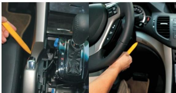
5. С помощью монтажных лопаток демонтируйте декоративную панель.
