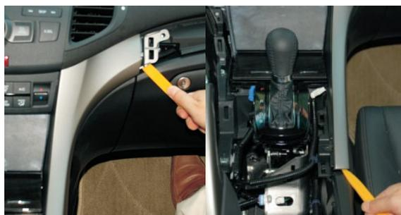
8. С помощью монтажных лопаток демонтируйте декоративную панель.
