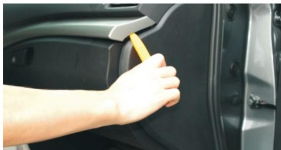
6. С помощью монтажных лопаток демонтируйте декоративную панель.
