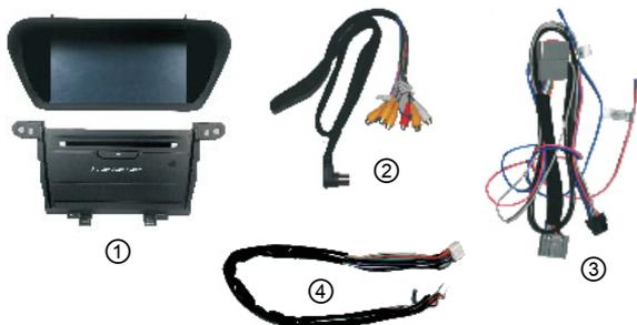
17. ① GPS экран и DVD-дисковод; ② AV проводка; ③ проводка микрофона; ④ DVD проводка.
