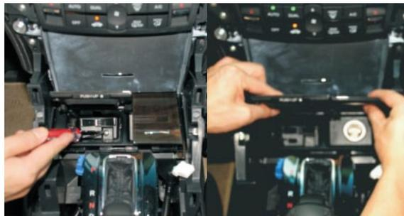
12. Демонтируйте прикуриватель с помощью отвертки, отсоедините проводку.
