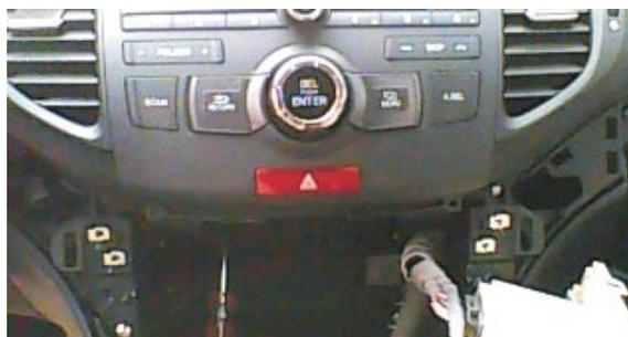
16. Открутите два винта, как показано на фото, и отсоедините проводку.
