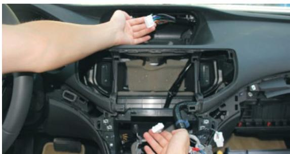
19. Установите проводку DVD, как показано на фото, конец с разъемом протяните сквозь отверстие.
