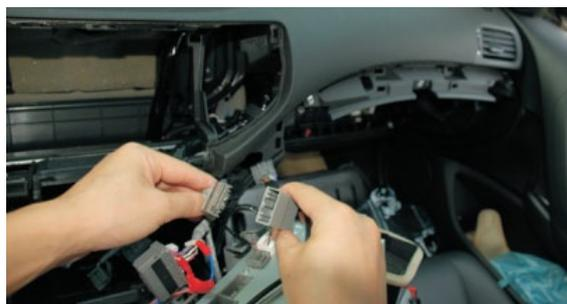
22. Соедините провода микрофона со штатным проводами микрофона.
