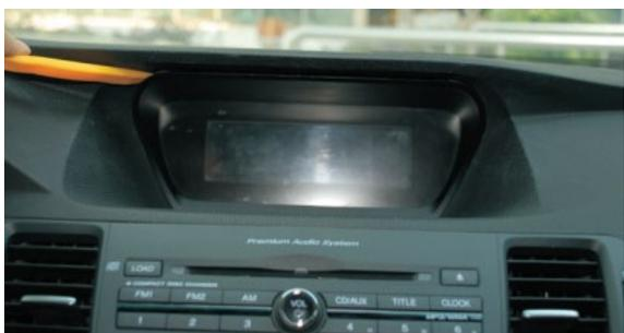
15. С помощью монтажных лопаток демонтируйте штатный экран.
