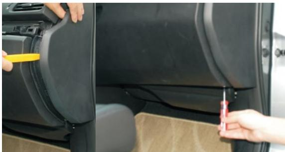
9. С помощью монтажных лопаток демонтируйте боковую декоративную панель, затем открутите винты под перчаточным отделением.
