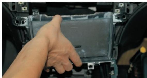
14. Снимите кондиционер и перчаточное отделение, затем отсоедините проводку.
