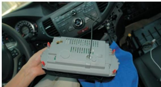
26. Закрепите крепежные элементы на GPS модуле.
