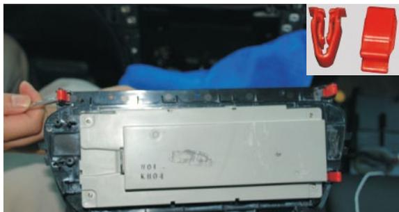
25. Снимите 4 крепежных элемента со штатного экрана.
