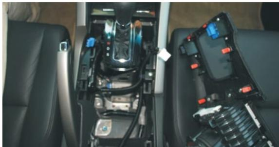
3. Демонтируйте декоративную панель и отсоедините проводку, не повреждая крепеж.
