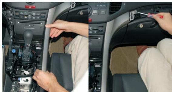
38. Установите и зафиксируйте винтами правую декоративную панель на консоли.
